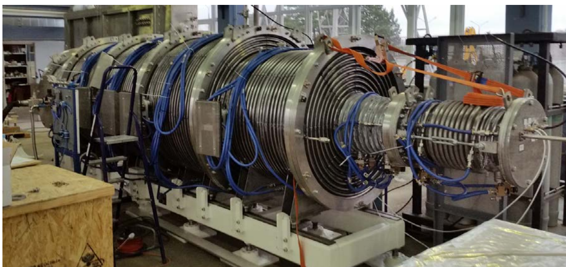
Рисунок 6 – Внешний вид печи спекания с установленным выходным фланцем
