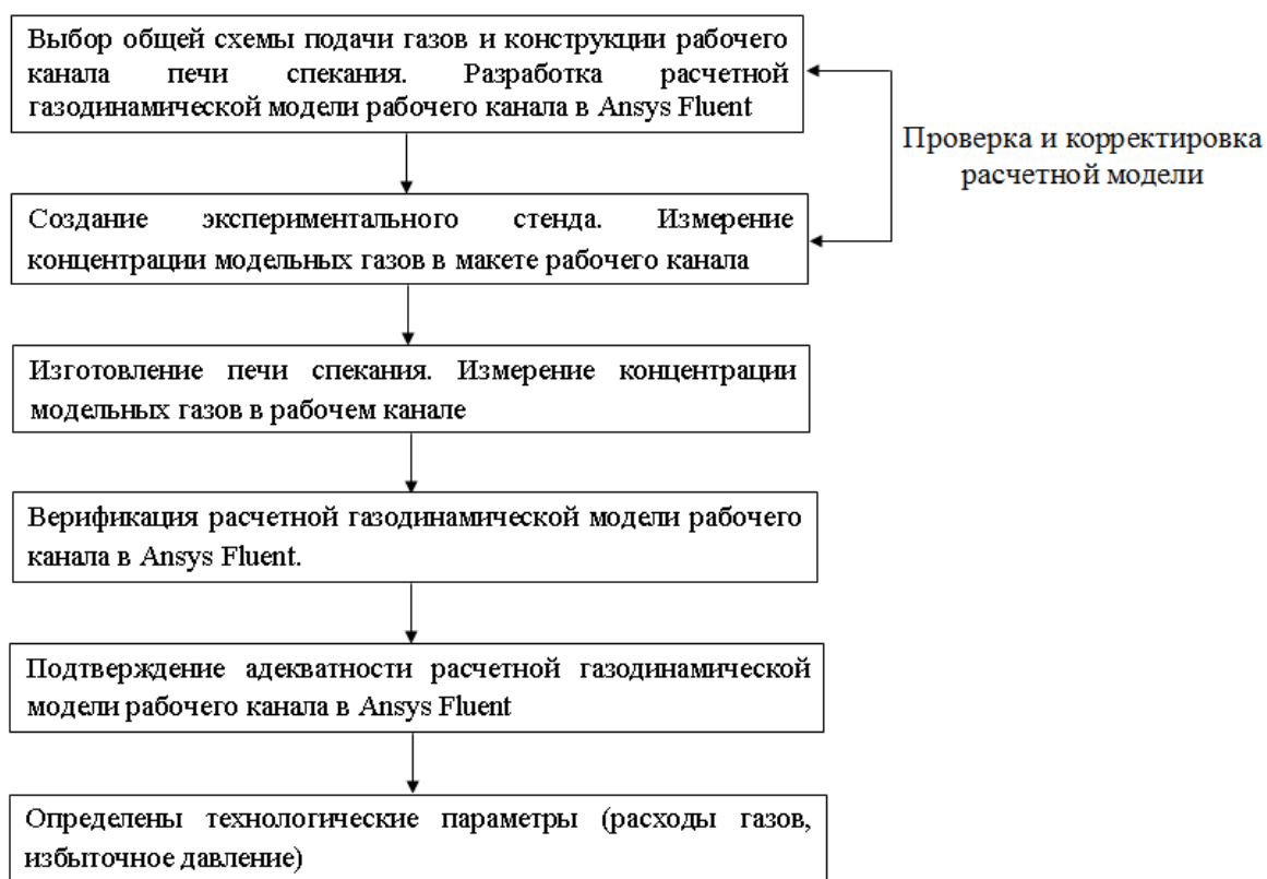
Рисунок 1 – Последовательность расчетно-экспериментального обоснования конструкции рабочего канала печи спекания
