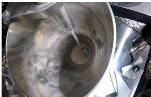
Рисунок 2 – побудитель порошка в форме штопора
