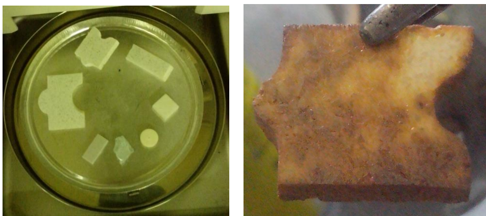
Рисунок 9 – фотографии образцов до (слева) и после (справа) ресурсных испытаний
