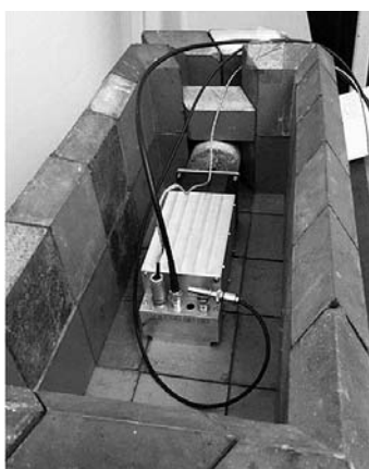
Рис. 3. Детектор на основе сцинтиллятора LaBr 3 внутри свинцовой защиты
