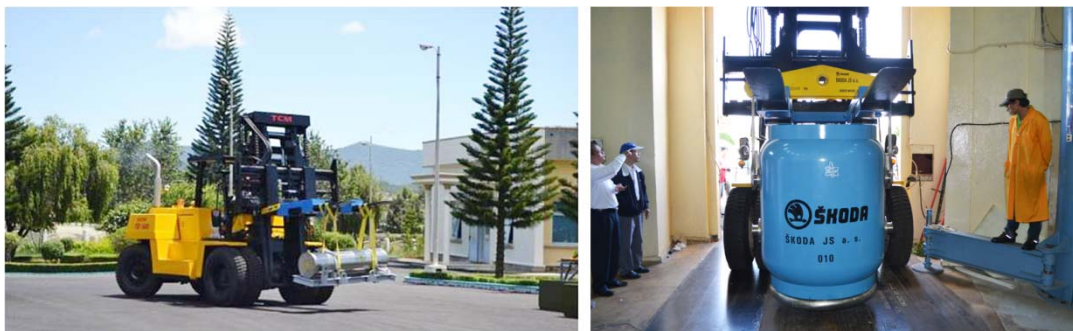
Рис. 1. Выгрузка оборудования и доставка контейнера SKODA VPVR/M в реакторный зал с использованием автопогрузчика
