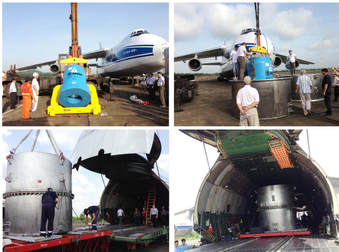
Рис. 4. Формирование упаковки ТУК-145/С и загрузка в самолет Ан-124-100
