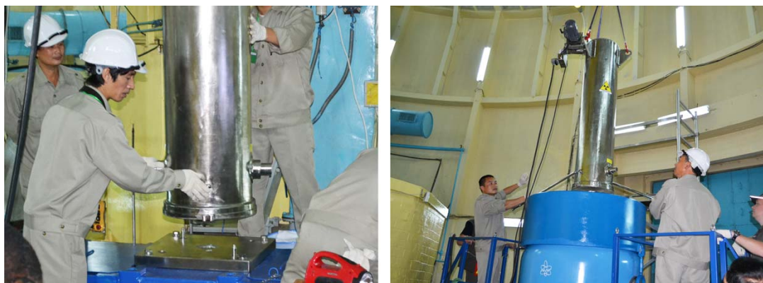
Рис. 3. Извлечение ОТВС из хранилища и загрузка в контейнер SKODA VPVR/M с использованием перегрузочного контейнера
