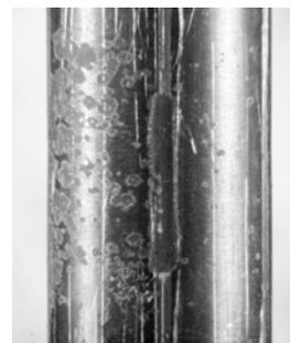
Рис. 4. Следы взаимодействия стальной ДР с оболочкой твэла РБМК с выгоранием топлива менее 20 МВт сут/кгU
