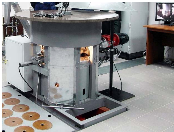
Рис. 3. Прототип установки для резки пеналов и капсулирования ОТВС
