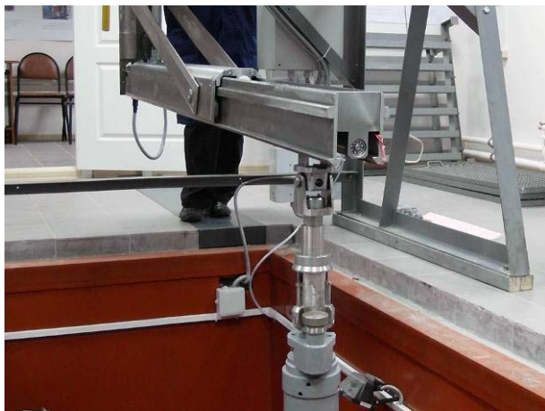
Рис. 2. Прототип манипулятора для извлечения пеналов с ОТВС из БВ
