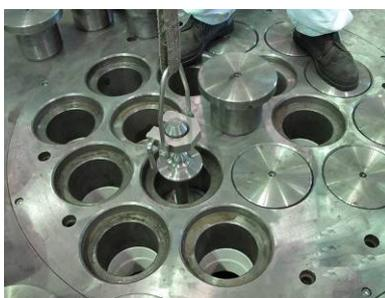
Рис.8. Испытания оснастки для обращения с ТУК и ампулами на ПО «Маяк»
