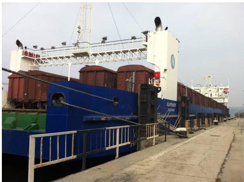
Рис. 3. Паром «Славянин», использованный для перевозки порожних ТУК-19
