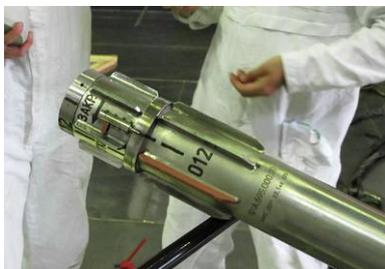
Рис.7. Ампула для перевозки ПТ некондиционных ОТВС РБМК
