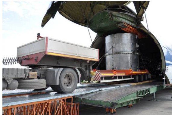
Рис. 5. Загрузка ТУК-145/С в самолет Ан-124-100 на автомобиле с полуприцепом
