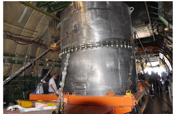
Рис. 5. Загрузка ТУК-145/С в самолет Ан-124-100 на автомобиле с полуприцепом
