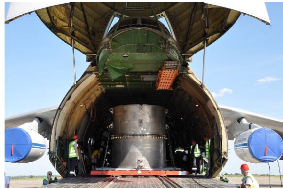
Рис. 4. Загрузка ТУК-145/С в самолет Ан-124-100 с использованием роликовой системы
