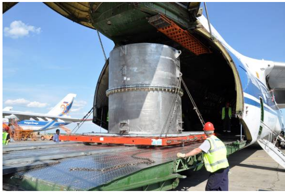
Рис. 4. Загрузка ТУК-145/С в самолет Ан-124-100 с использованием роликовой системы
