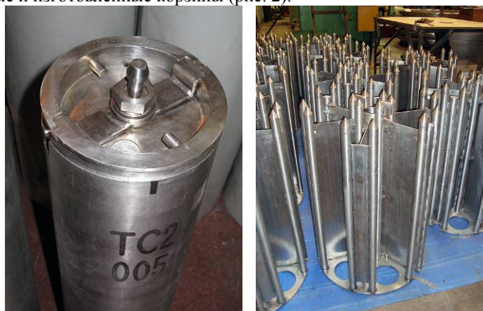
Рис.2. Негерметичные пеналы для ОЯТ и корзины для ТУК SKODA VPVR/M
