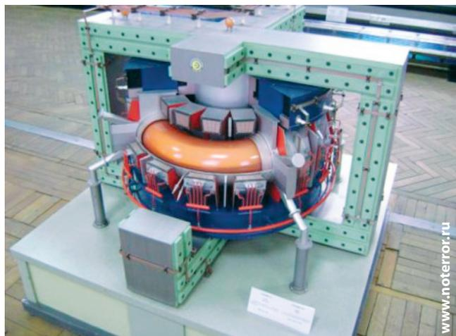
Макет реактора передвижной АЭС «Памир-630Д»
