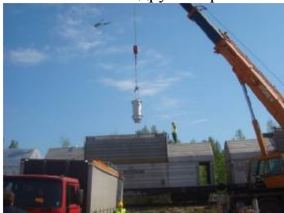
Рисунок 1. Погрузка контейнеров ТУК-19 на автомобиль (а) и в вагон-контейнер ТК-5 (б)
