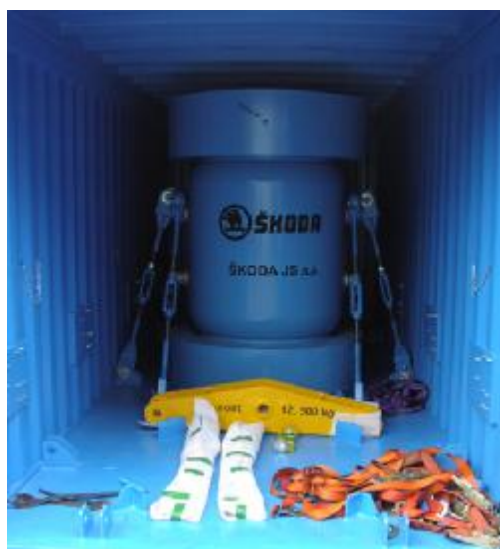
Рисунок 2. Размещение контейнера SKODA VPVR/M в ISO-контейнере
