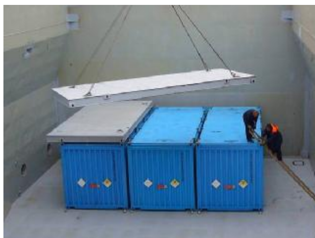
Рисунок 11. Загрузка ISO-контейнеров с ТУК SKODA VPVR/М в трюм судна «MCL-Trader»
