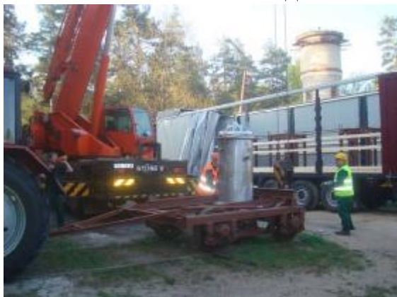
Рисунок 1. Погрузка контейнеров ТУК-19 на автомобиль (а) и в вагон-контейнер ТК-5 (б)
