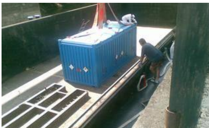
Рисунок 4. Погрузка ISO-контейнеров с контейнерами SKODA VPVR/M на баржу типа «река-море»
