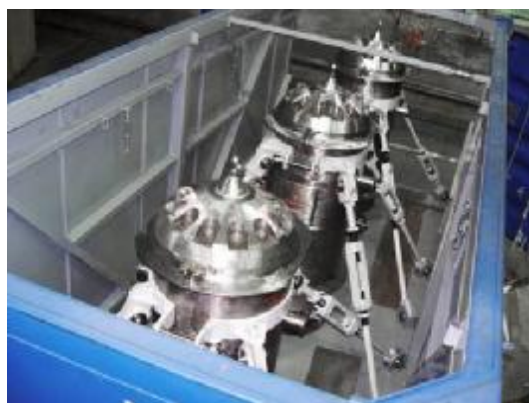
Рисунок 8. Транспортный пакет на основе грузового ISO-контейнера для перевозки ТУК-19
