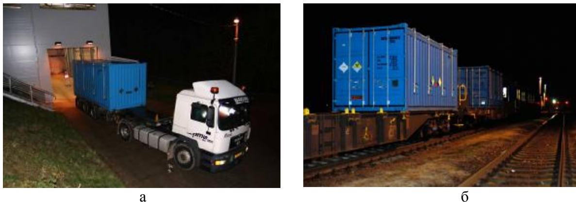
Рисунок 3. Транспортирование ISO-контейнеров с контейнерами SKODA VPVR/M автомобильным (а) и ж/д (б) транспортом
