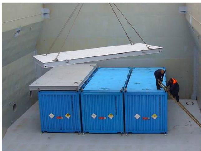
**Рисунок 11. Загрузка ISO-контейнеров с ТУК SKODA VPVR/M в трюм судна «MCL-Trader»**
