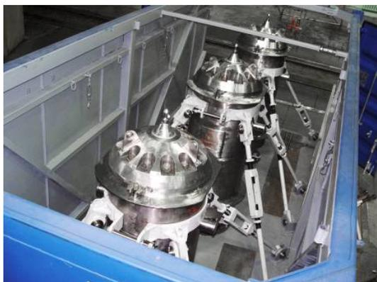
**Рисунок 8. Транспортный пакет на основе грузового ISO-контейнера для перевозки ТУК-19**
