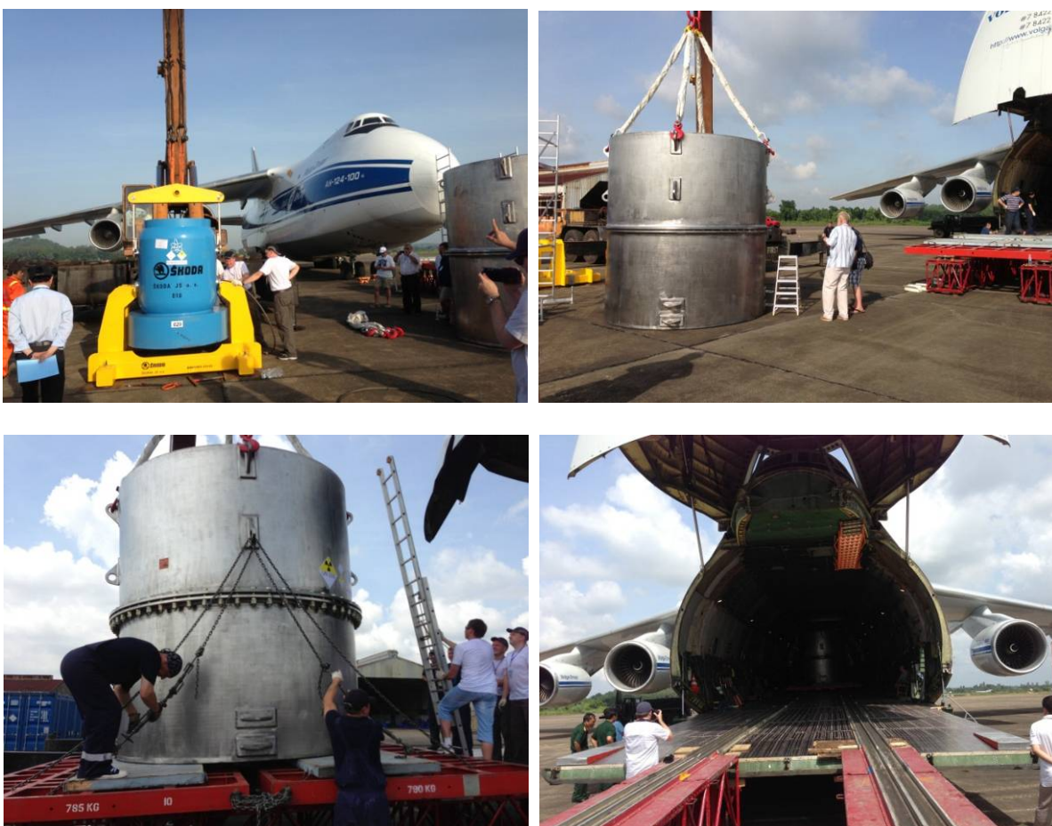
Рисунок 10. Формирование ТУК-145/С и загрузка в самолет
