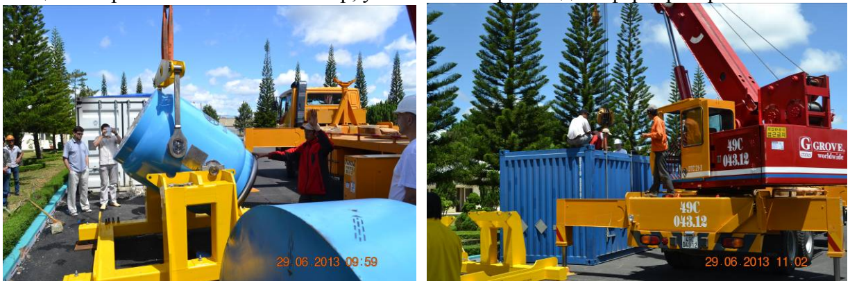
Рисунок 7. Размещение контейнера SKODA VPVR/M на кантователе и его загрузка в ISO-контейнер
