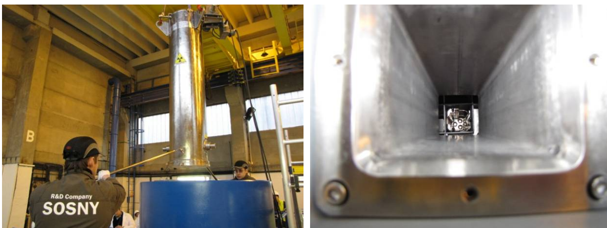
Рисунок 5. Испытания на совместимость оборудования для загрузки ОТВС ВВР-М2 с контейнером SKODA VPVR/M
