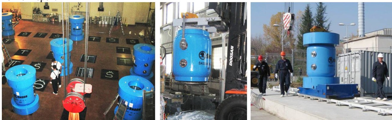
Рис. 10. Размещение контейнеров в реакторном зале. Погрузчик и тележка для перемещения контейнеров
