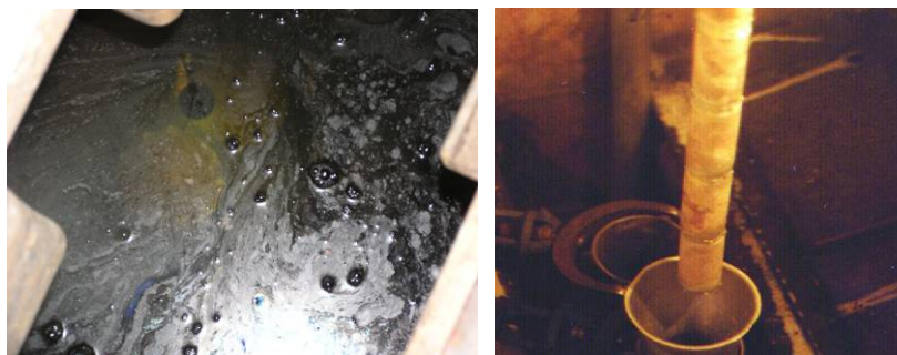
Рис. 4. Вода бассейна выдержки и поврежденные ОТВС
