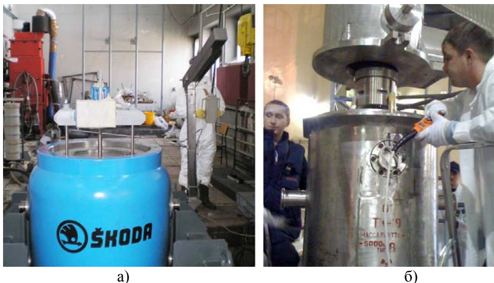
Рис. 9. Загрузка ТУК SKODA VPVR/M над бассейном (а). Проверка оборудования перед загрузкой ТУК-19 с помощью перегрузочного контейнера (б)
