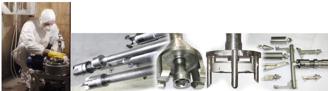
Рис. 8. Оборудование и инструменты для перетаривания ОЯТ
