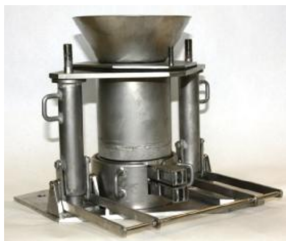
Рисунок 2. Схема (а) и внешний вид (б) устройства рассева: 1 – стойка; 2 – прижимная плита; 3 – колонка сит; 4 – крышка-воронка; 5 – фильтровальный элемент; 6 – корпус блока фильтров
