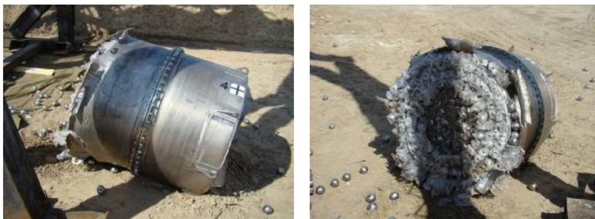
Рисунок 10. Макет ТУК-145/С после испытаний
